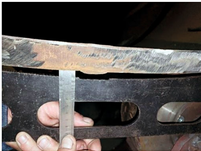
Рис. 2. Проведение контроля отклонения профиля наружной поверхности торца трубы
