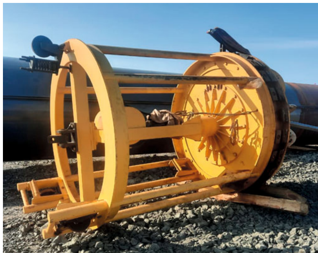
Рис. 5. Центриратор внутренний гидравлический
